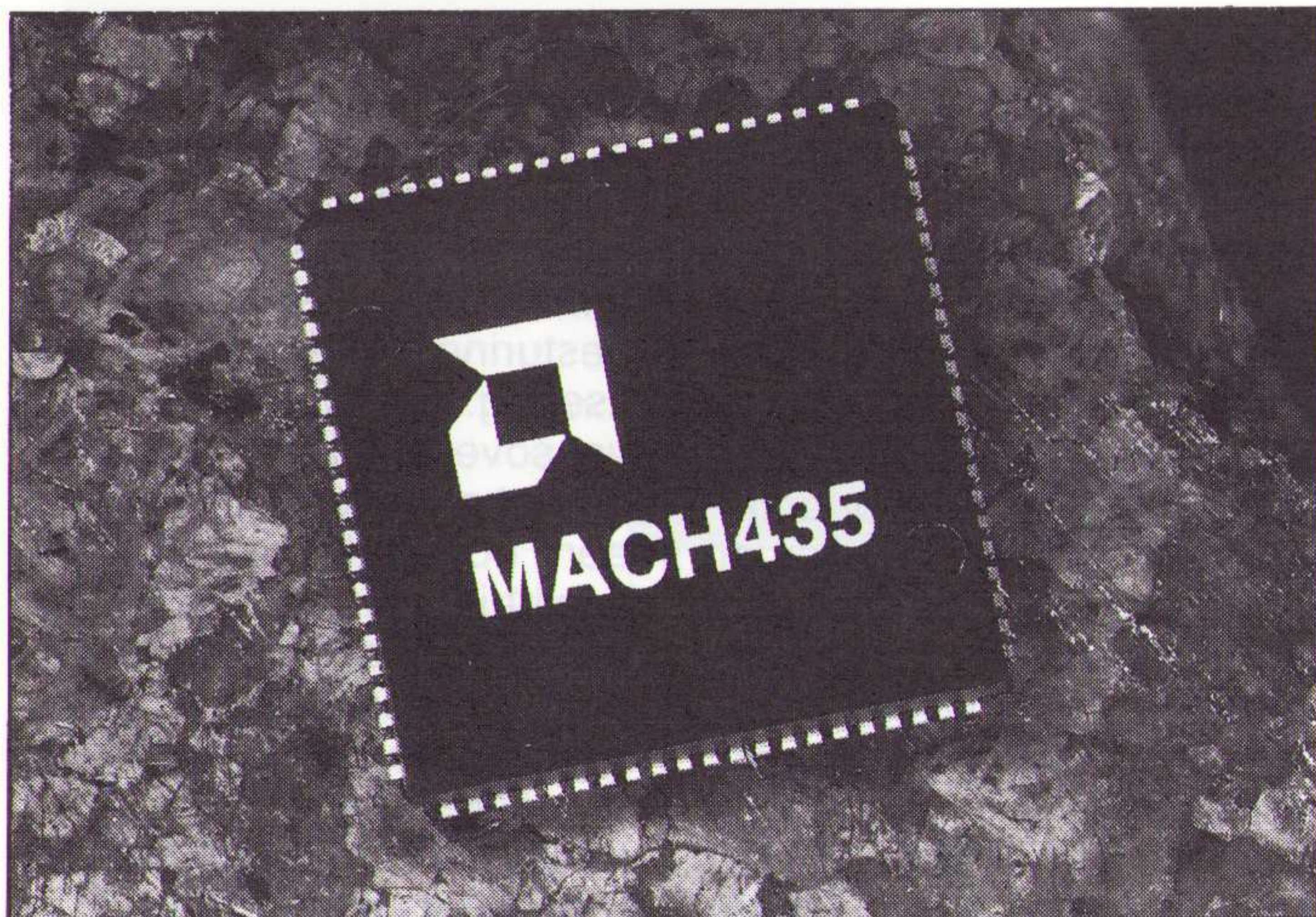
Een PLD met 5000 poorten, 128 macrocellen en 84 aansluitpennen.
